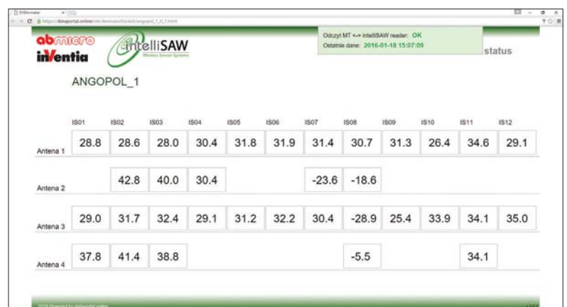
Rys. 2 Ekran diagnostyczny – wszystkie czujniki temperatur zainstalowane na obiekcie
